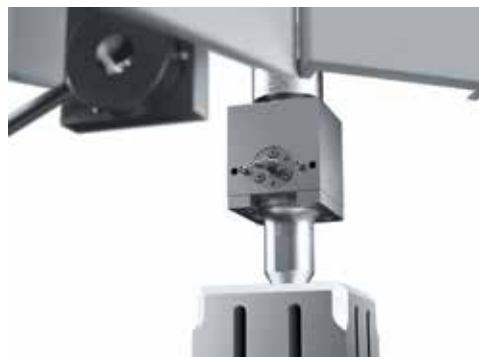
Rys. 5 | Szybka i łatwa zamiana jednostek drgających
